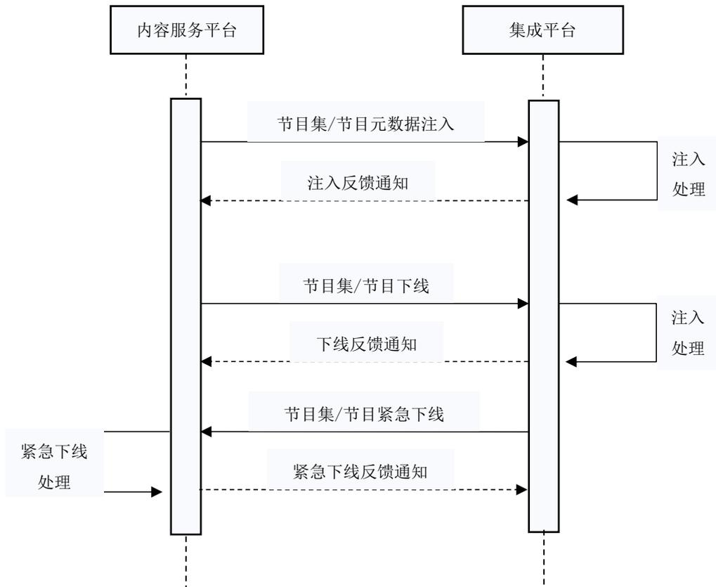
图 2 节目集成系统与内容服务平台的对接流程
